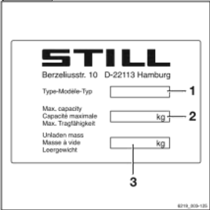
Plaque constructeur du bac de remplacement
